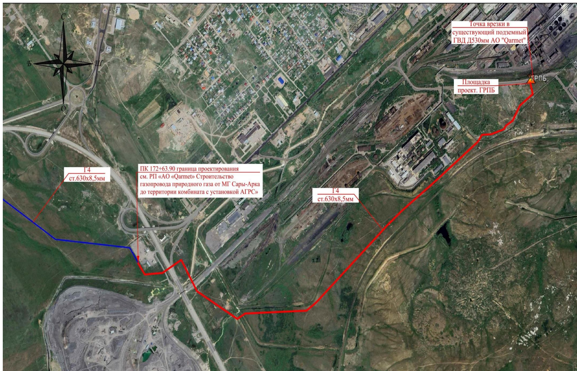
Рисунок 1.1 – Ситуационная схема объекта намечаемой деятельности (газопровод высокого давления 1,2 МПа)
